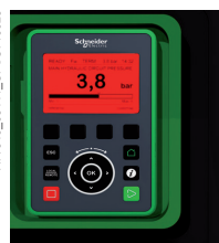
Erreur détectée : le rétroéclairage rouge de l'écran s'active automatiquement
